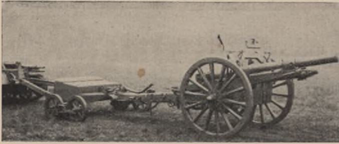
Skombinowana dźwigarka artyleryjska i transporter dla polowej artylerji. — Traktor z jaszczykiem i transporterem.
