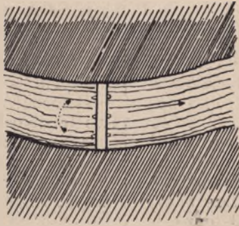
Rys. 6. Niszczenie mostu zapomocą min pływających
