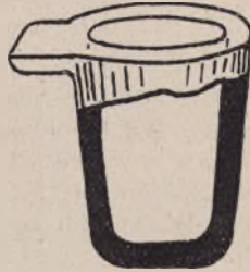
Rys. 1 Tygiel żeliwny do kąpeli ołowianej
