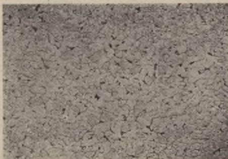
Żelazo o zawartości 1/10 węgla przed zahartowaniem (powiększenie 100-krotne)
