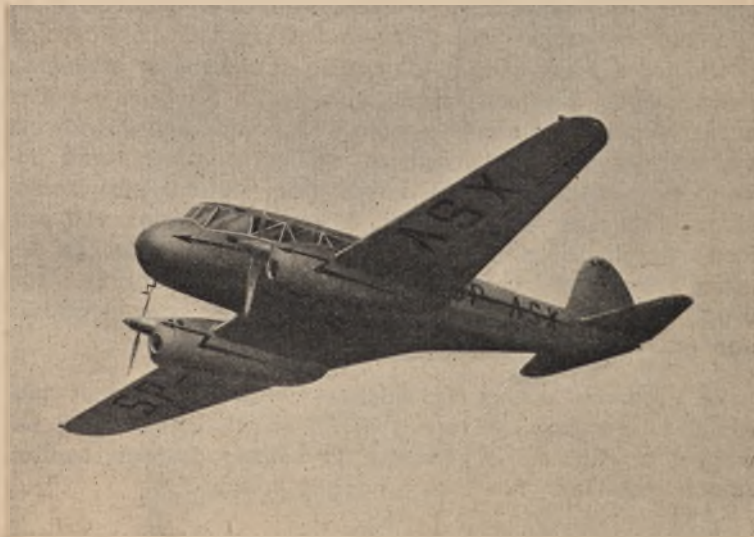
Samolot komunikacyjny R. W. D. -11. 2 silniki o mocy 205 K.M. każdy, 6 miejsc pasażerskich i 2 obsługi. Szybkość maksymalna około 300 km/godz. Fot. Jan Ryś
