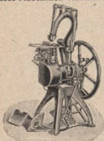
Drahtheftmaschine „Universal“ Nr. 7½ f. Brosch. Blocks etc. b. z. 23 mm Dicke
