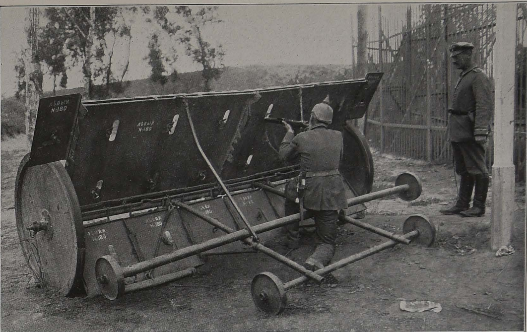
Erprobte russische fahrbare Panzerschirme mit Schießscharten. (Phot. A. Groß.)
