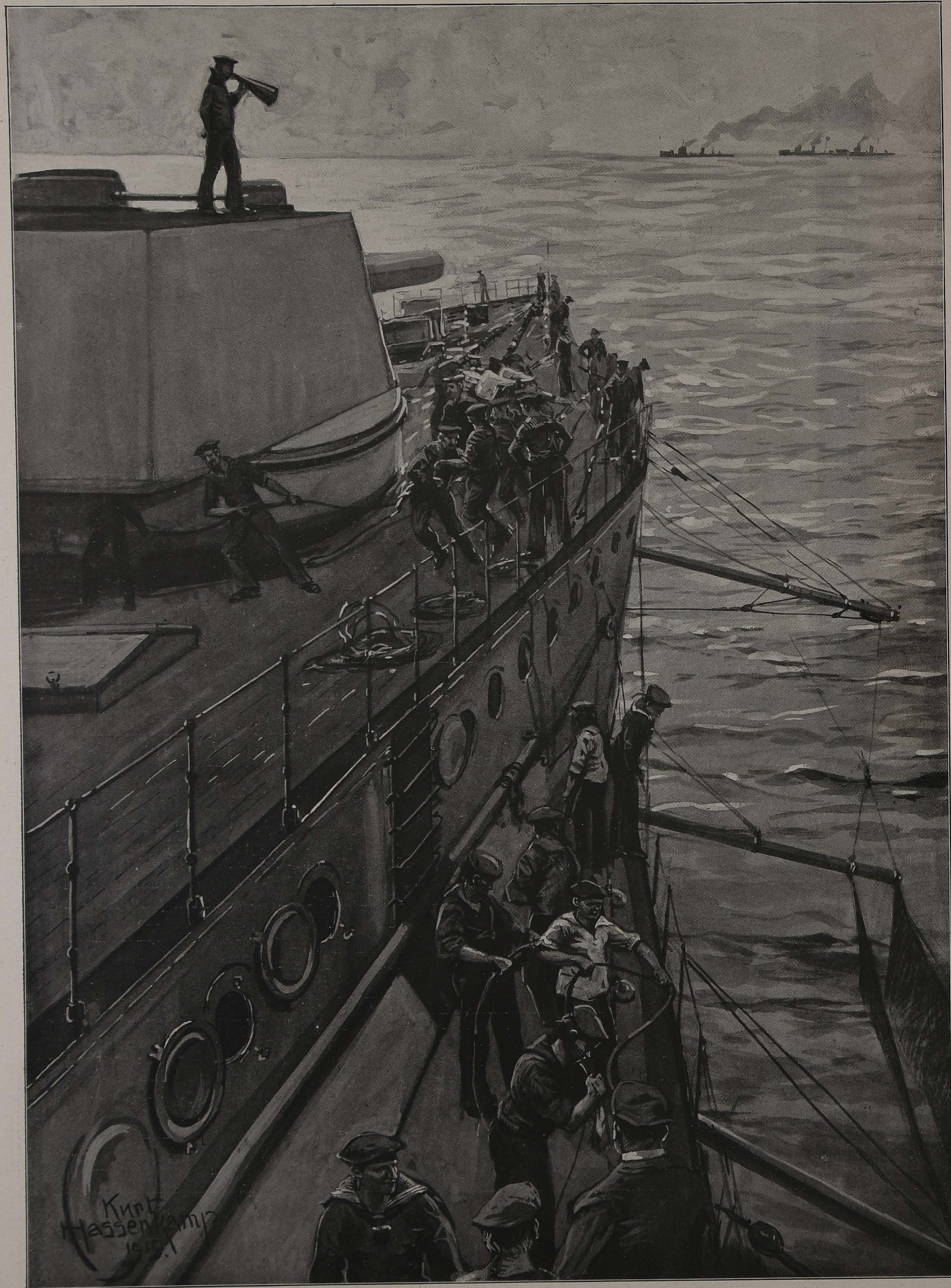
Unsere Marine im Weltkrieg: Ausbringen der Torpedoschutzneke auf einem Panzerkreuzer.
