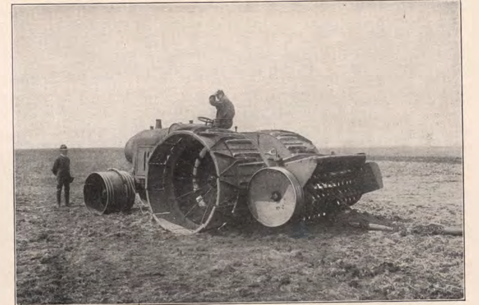
Landbaumotor-Lanz (Umbruchmaschine), mit der das Land durchgearbeitet wird.
