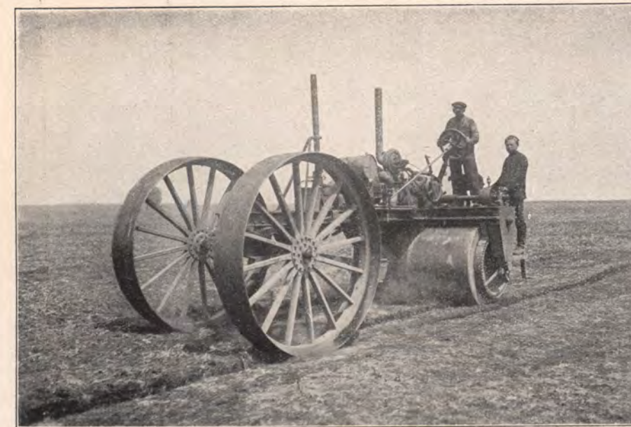
Ergomobil-Wiesenwalze beim Walzen des umgearbeiteten Bodens.
